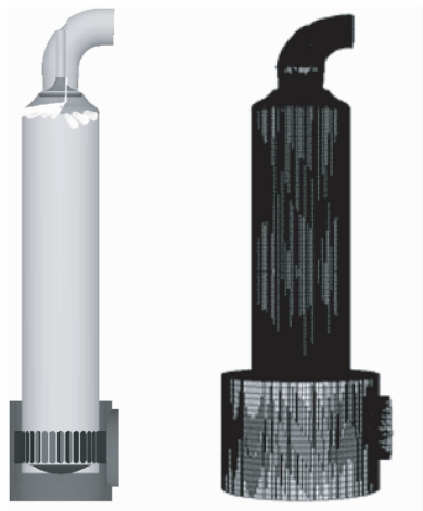
图 1 船用双燃料发动机模型的三维图和计算网格
